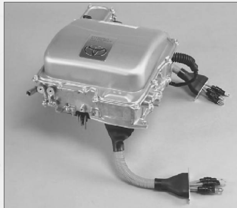
Ηλεκτρονική μονάδα διαχείρισης υψηλής τάσης (HV -High Voltage) σε Toyota. Το χρώμα των καλωδίων είναι πορτοκαλί
