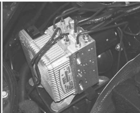
Υδραυλική μονάδα SBC με ενσωματωμένο εγκέφαλο
