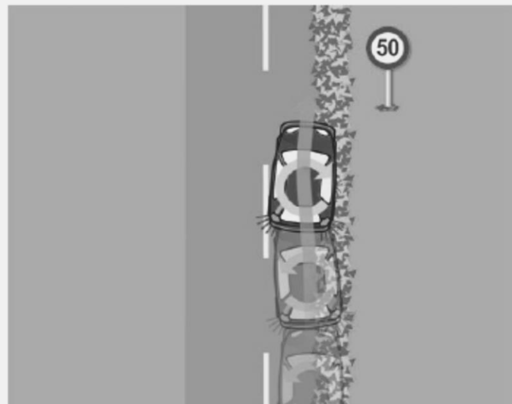
Αυτοκίνητο με υποβοήθηση ανάποδου τιμονιού
