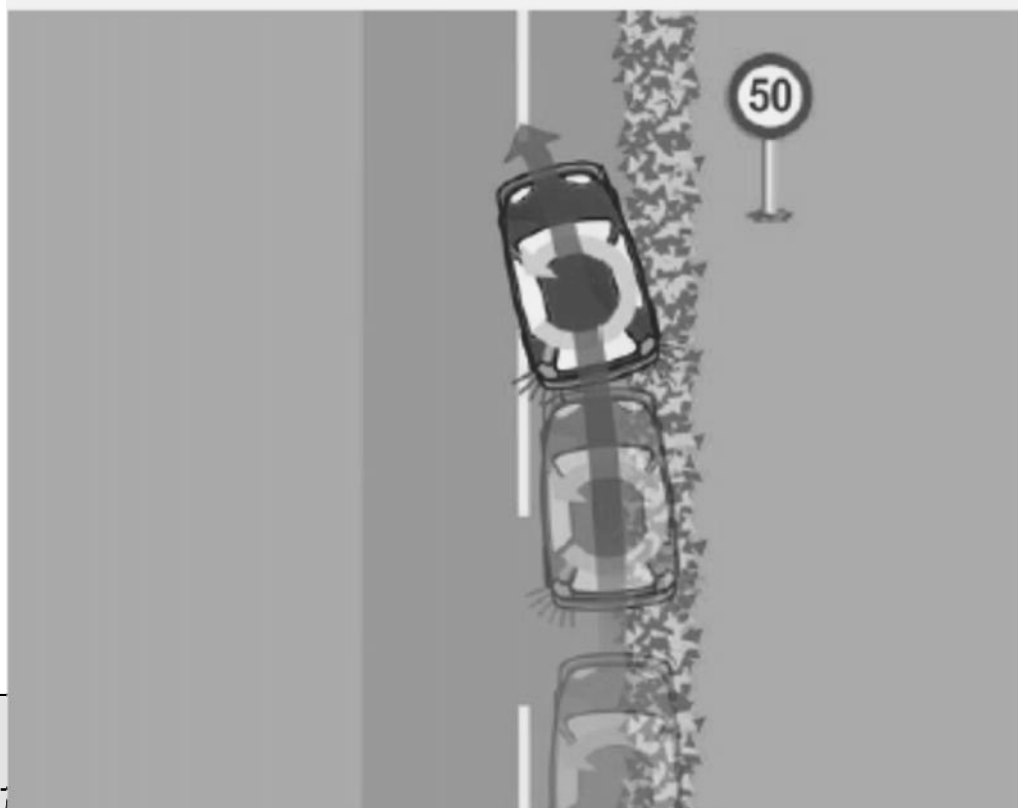
Αυτοκίνητο χωρίς υποβοήθηση ανάποδου τιμονιού
