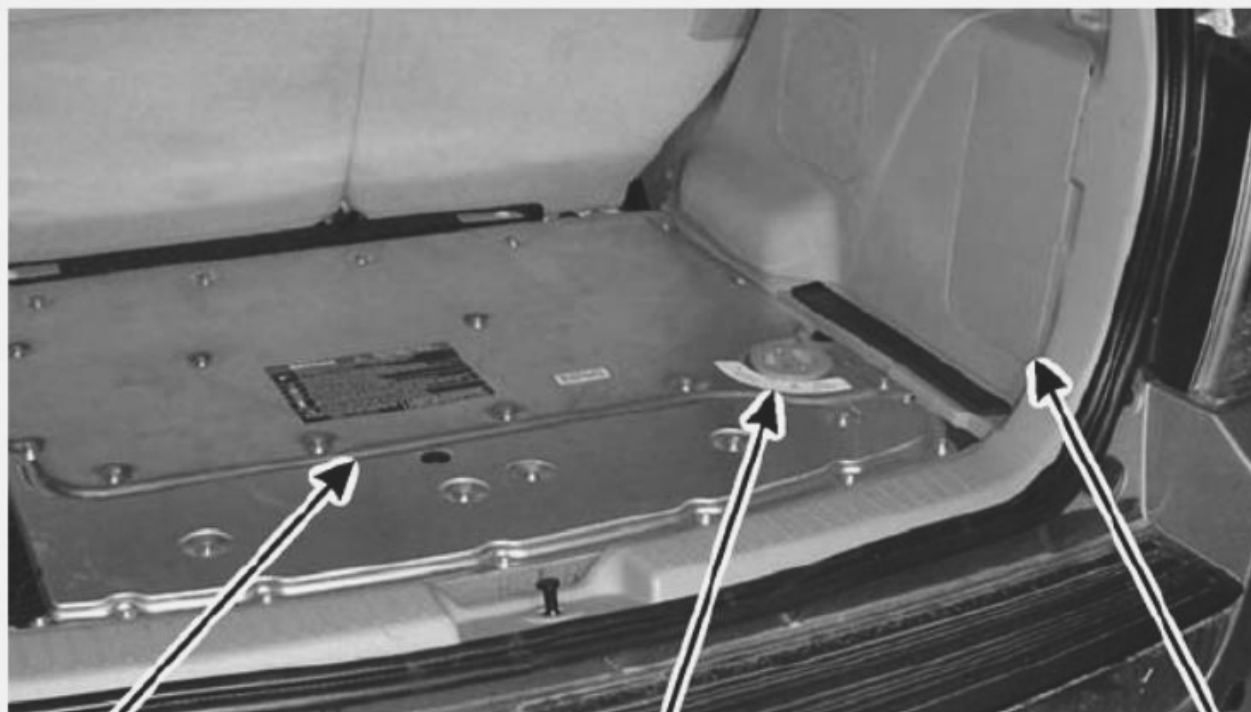
Διακόπτης Υψηλής Τάσης που βρίσκεται πίσω από την πλαϊνή επένδυση
